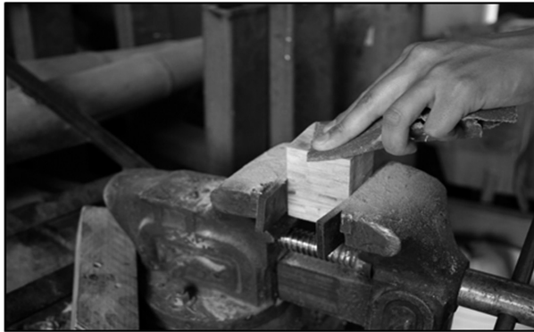
Figura 18. Fabricación de probetas AnLVPe.
