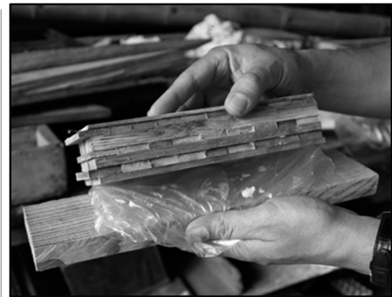
Figura 7. Fabricación de probetas AnLCPa.
